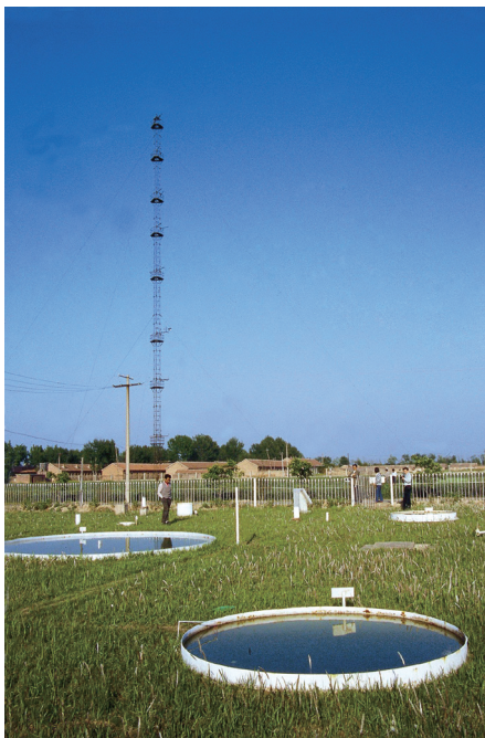
禹城站的水面蒸发观测场 © 赵士洞/CERN
