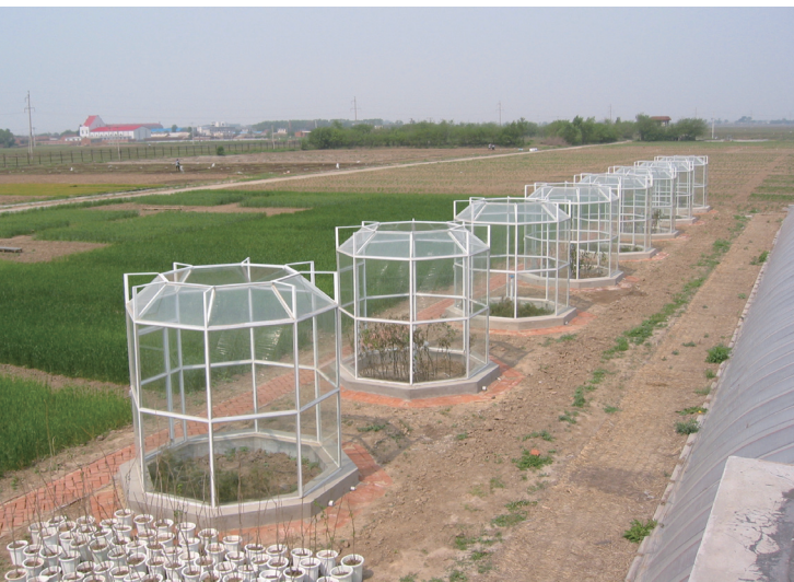
开顶式二氧化碳倍增设施 © 沈阳站/CERN
